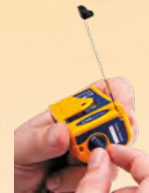
Rembobinage de l'antenne
