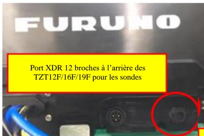
Port XDR 12 broches à l'arrière des TZT12F/16F/19F pour les sondes
