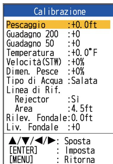
**[Pescaggio]:** la visualizzazione della profondità predefinita mostra la distanza dal trasduttore. Per mostrare la distanza dalla superficie del mare, impostare il pescaggio dell'imbarcazione.
