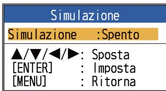
**[Simulazione]**: la modalità di simulazione permette, senza collegare il trasduttore, l'utilizzo simulato dell'apparecchiatura mediante echi generati internamente. Tutti i controlli sono operativi. Nell'angolo inferiore destro della schermata appare il messaggio [DEMO] quando è attiva la modalità di simulazione.
