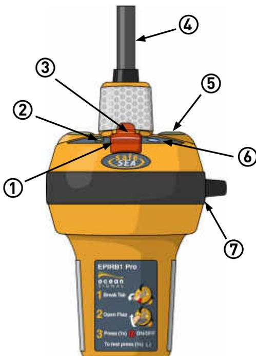
**!** Il cordino è fornito per consentire di fissare l'EPIRB1 Pro alla scialuppa di salvataggio o a una persona, una volta attivato. **Non utilizzare il cordino per fissare l'EPIRB1 Pro all'imbarcazione, onde evitare la perdita del dispositivo in caso di affondamento del natante.**
