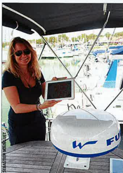
▲ Avec un radar Wi-Fi, ne reste plus qu'un seul fil, celui nécessaire à l'alimentation du radôme...
