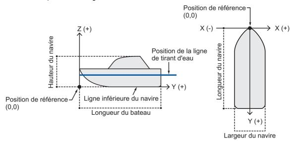
**Remarque:** Les valeurs d'emplacement de l'antenne et de calcul de vitesse requièrent les dimensions du navire. Si les dimensions du navire ne sont pas encore définies, recommencez cette procédure.
