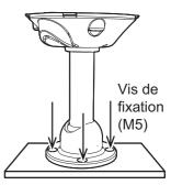
7. Desserrez les quatre vis de fixation du socle d'antenne à l'aide de la clé hexagonale fournie et ajustez le sens du tube tout en gardant à l'esprit que le trou de fixation est dirigé vers la proue du navire, comme illustré ci-dessous.
