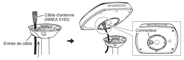
10. Enroulez de l'adhésif auto-vulcanisant en faisant deux tours au niveau de la jonction entre les connecteurs d'antenne et le câble d'antenne. Puis, enroulez une couche d'adhésif vinyle par-dessus l'adhésif auto-vulcanisant pour l'étanchéité.
