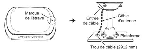
4. Faites quatre trous de montage (φ4,2 à 5 mm) sur la plateforme de montage.
