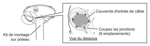
Placez les colliers de serrage sur le kit de montage sur poteau et faites passer le câble d'antenne NMEA 0183 depuis le dessous via l'entrée de câble du kit de montage sur poteau. Ensuite, raccordez le câble d'antenne NMEA 0183 au connecteur de l'antenne.
