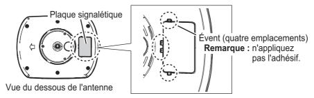
5. Enroulez de l'adhésif auto-vulcanisant **en faisant deux tours** au niveau de la jonction entre les connecteurs d'antenne et le câble d'antenne. Puis, enroulez **une couche** d'adhésif vinyle par-dessus l'adhésif auto-vulcanisant pour l'étanchéité.
