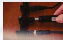
WindyPlug est une extension du BaroPlug qui reçoit une interface pour connecter un capteur de vent à ultrasons. Toutes les données sont ainsi transmises sur le réseau NMEA2000 !
